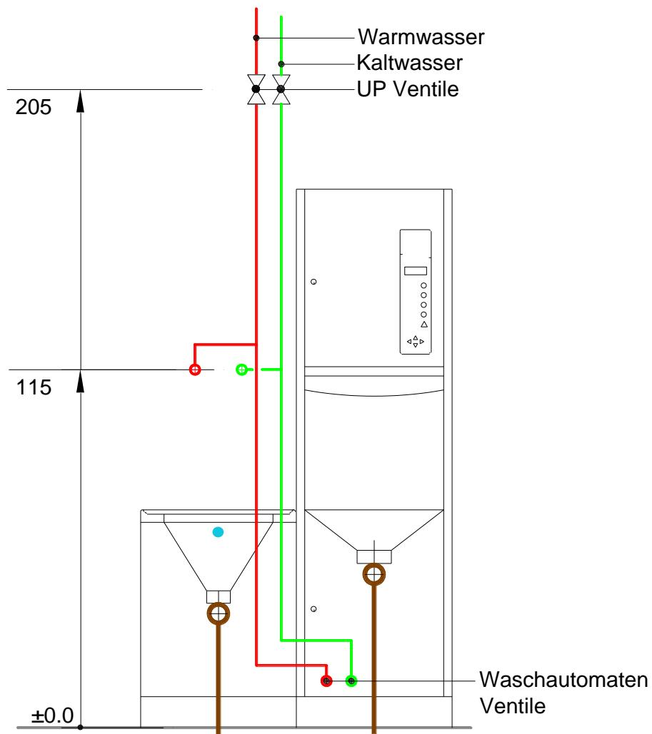
Wenn die Anschlussleitungen über einen absperrbaren Pexverteiler von der Hohldecke erschlossen sind, wird auf UP Ventile verzichtet
